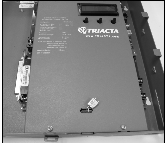
(2) Metrological Sealing Location / (2) Emplacements du sceau métrologique
