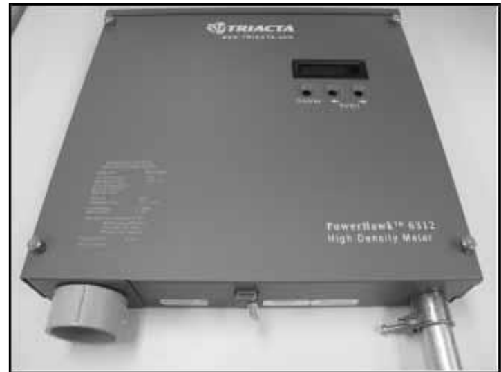
(2) Installation Sealing Location / (2) Emplacement du sceau d'installation
