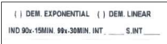
Demand Nameplate / La plaque signalétique pour la puissance
