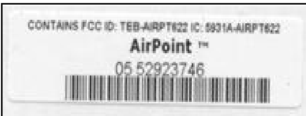
Rev.4: Focus II with Modular HP AirPoint (Note: No Landis+Gyr marking on label) Rév. 4: Focus II avec Modular HP AirPoint (Note: Aucun titre Landis+Gyr sur le l'étiquette)
