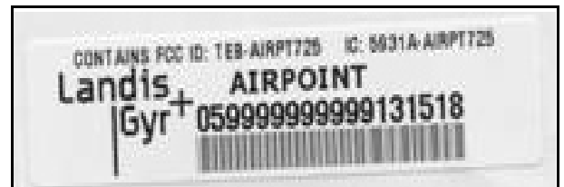
Rev.4: Focus II with Integrated HP AirPoint (Note: Presence of Landis+Gyr marking on label) Rév. 4: Focus II avec HP AirPoint (Note: Présence du titre Landis+Gyr sur l'étiquette)
