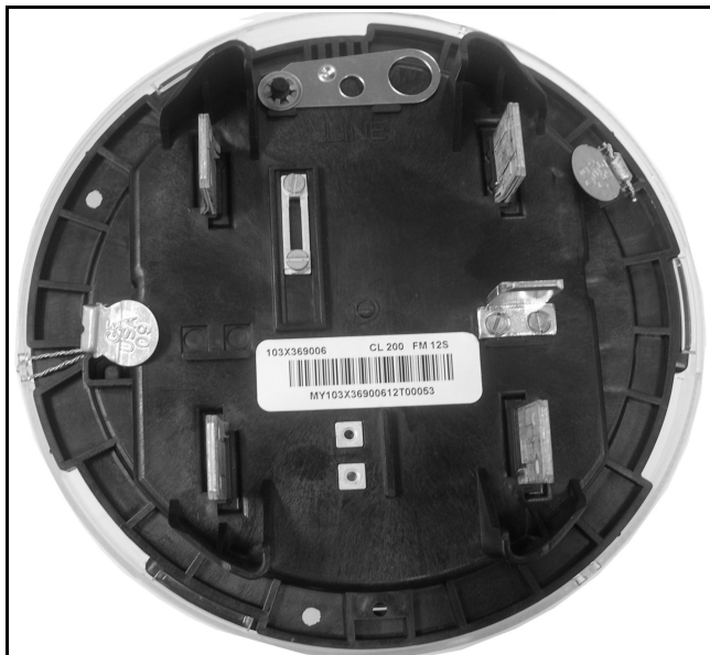
Rev. 6 New sealing method: two seal/barrier Rév. 6: Nouvelle méthode de scellage: deux scellés/barrière
