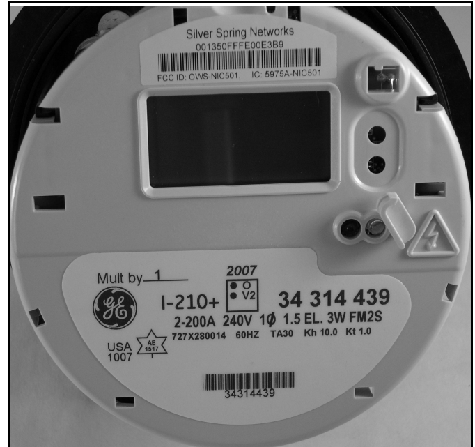
I-210+ with Silver Spring Networks I-210+ avec module Silver Spring Networks
