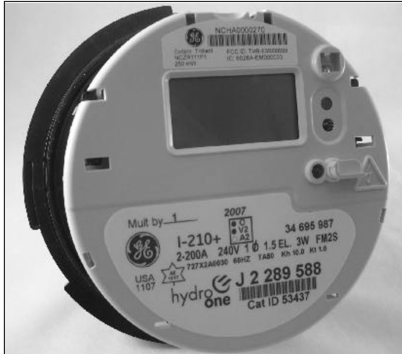
I-210+ with Trilliant SecureMesh NCZR111PH-I210 module I-210+ avec module NCZR111PH-I210 de Trilliant
