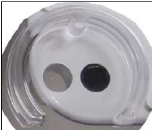
Epoxy Plug in the Optical Port / Le port optique est bouché avec de l'époxy
