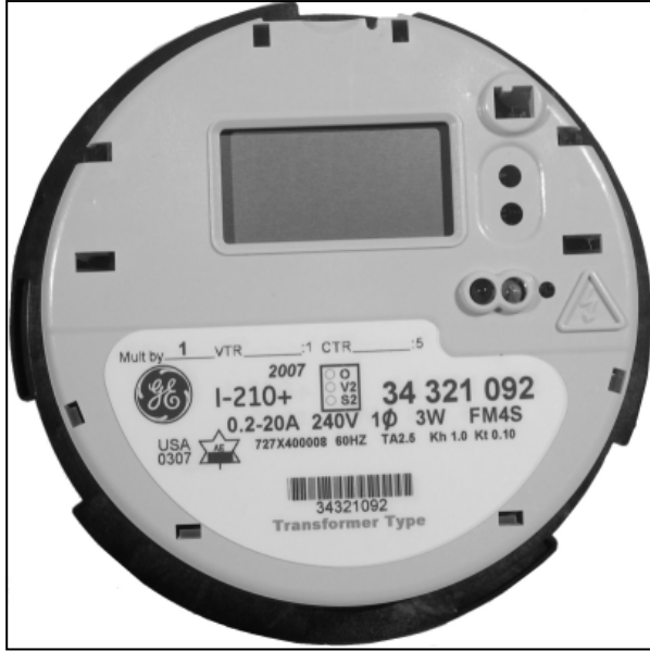
I-210+ Meter / Le compteur I-210+
