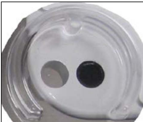
Epoxy Plug in the Optical Port / Le port optique est bouché avec de l'epoxy
