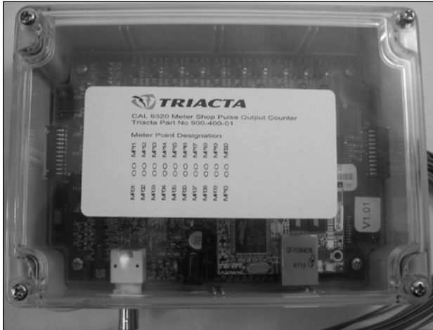
CAL 9320 Pulse Output Device / Appareil de sorties d'impulsions CAL 9320
