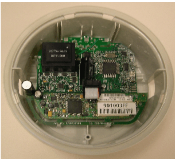
Focus Metrology board with Utilinet® 71920 AMR / Carte métrologique du compteur Focus avec LAC Utilinet® 71920
