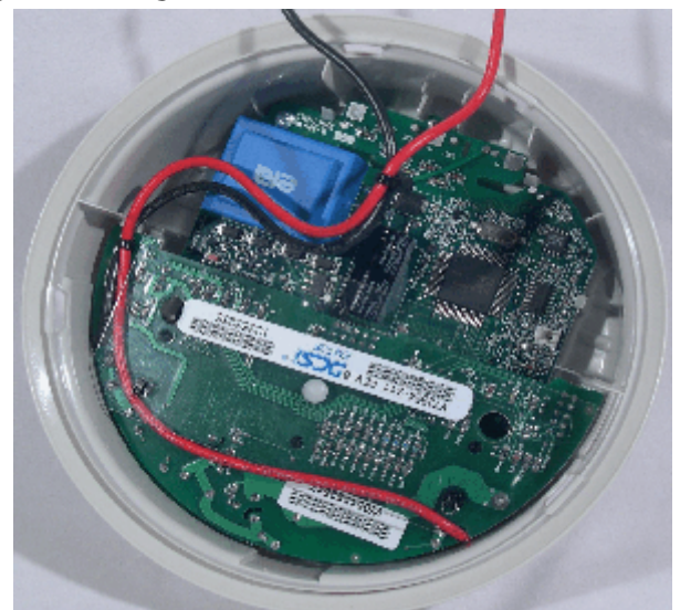
FOCUS Metrology board with DCSI EMT- 3F/Carte métrologique du FOCUS avec le DCSI EMT-3F
