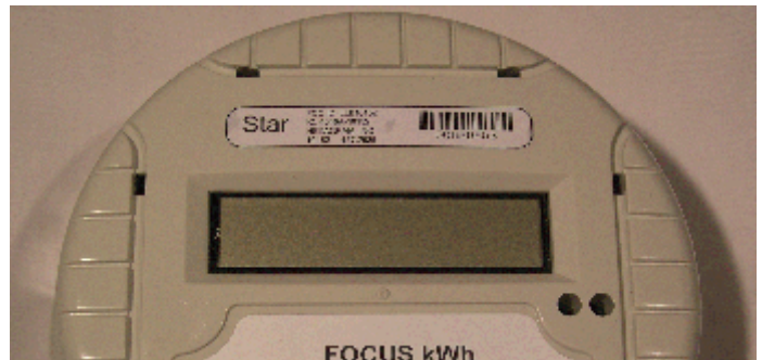
FOCUS meter with STAR MTU / Compteur FOCUS avec STAR MTU
