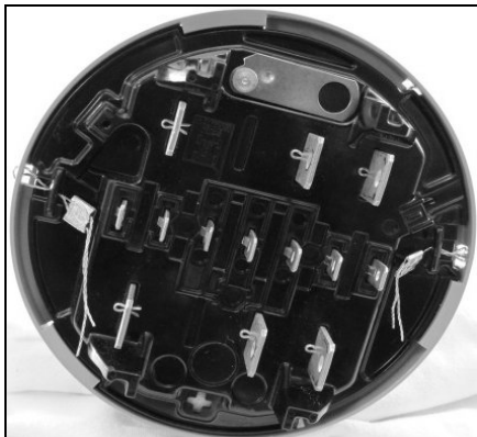
The sealing points on the meter's base / Les endroits de scellage à la base du compteur
