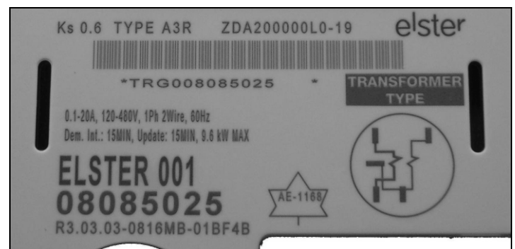
Alpha 3 Nameplate / Plaque signalétique de Alpha 3
