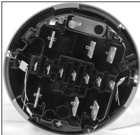
The sealing points on the meter's base / Les endroits de scellage à la base du compteur
