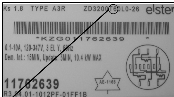
Example of markings identifier for meter types with communication cards/ Exemple d'identificateur de marquages des types de compteur avec une carte de communication
