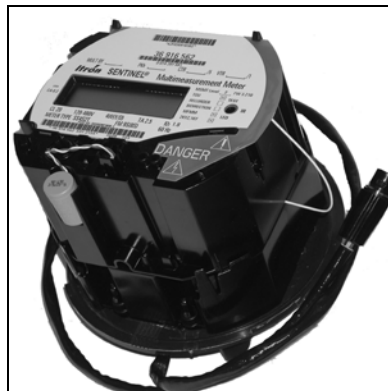
Meter with Cellnet MFMM module / Compteur avec le module MFMM de Cellnet
