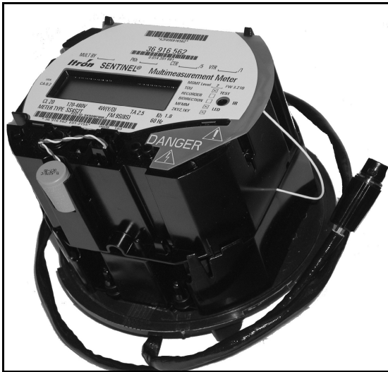
Meter with Cellnet module Compteur avec le module Cellnet
