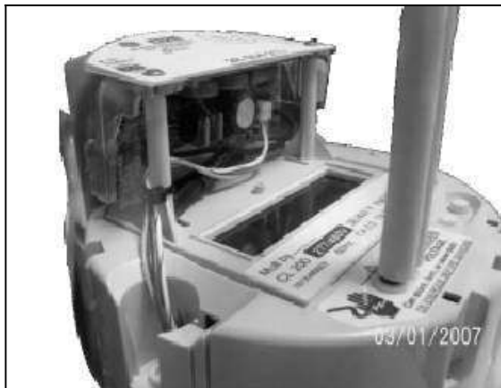
kV2c with external Turtle TS1 pulse counting AMR / kV2c avec lecteur automatisé de compteur externe Turtle TS1
