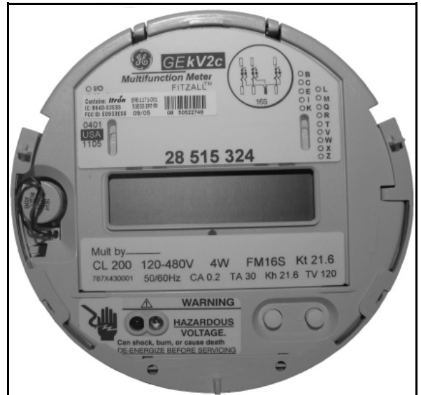
KV2c retrofitted with 53ESS Itron module/ KV2c avec le module 53ESS d'Itron
