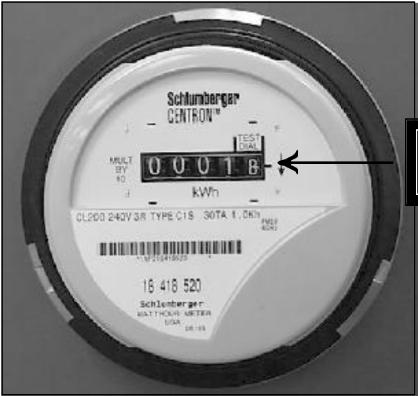
C1S Cyclometer ×10 Minuterie à tambour × 10
