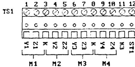
**Meter Input Wiring (2-Wire)**
